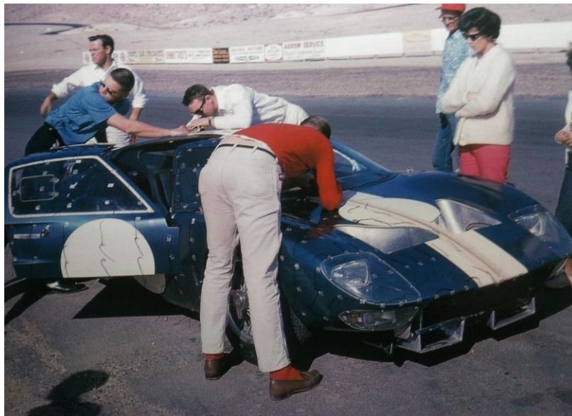
Figura 9: Teste aerodinâmico "novelo de lã" usado no desenvolvimento do mítico Ford GT40 [18]
