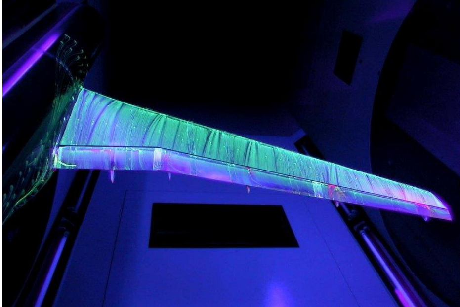
Figura 8: Utilização de tinta flow-vis no túnel de vento de baixa velocidade da Airbus em Bremen [17]
