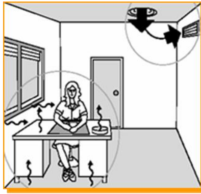
Figura 11- Escoamento de mistura em curto-circuito. [11]
