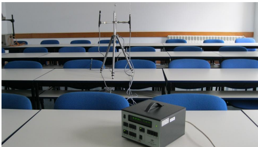
Figura 22- Aparelho de medição Indoor Climate Analyzer – Type 1213 da Bruel & Kjaer (1)
