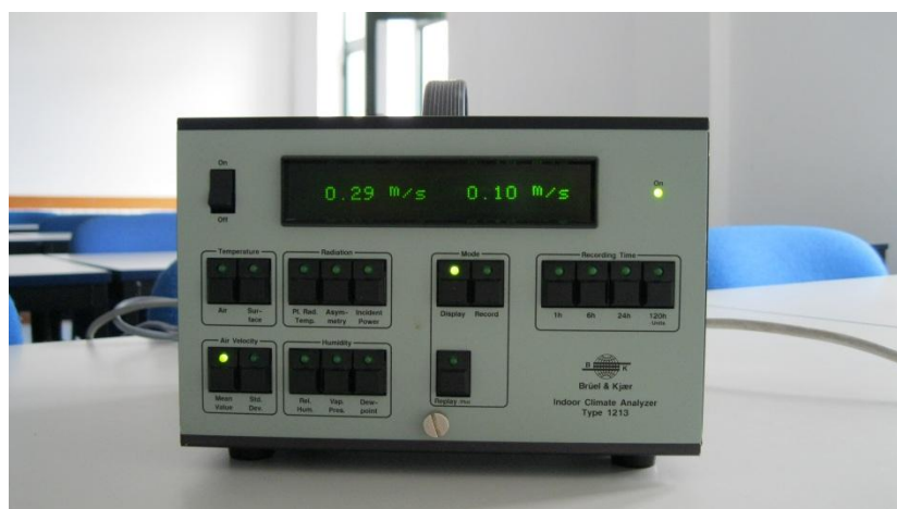
Figura 23- Aparelho de medição Indoor Climate Analyzer – Type 1213 da Bruel & Kjaer (2)
