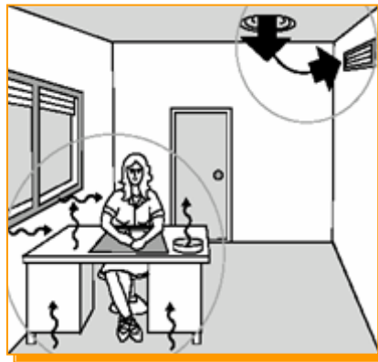
Figura 7- ventilação em “curto-circuito”. [11]
