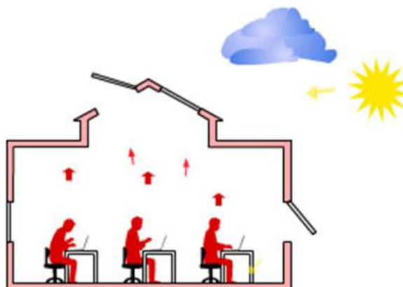
Figura 4- Esquema de ventilação feita através de uma abertura lateral e uma abertura no topo do edifício. [4]
