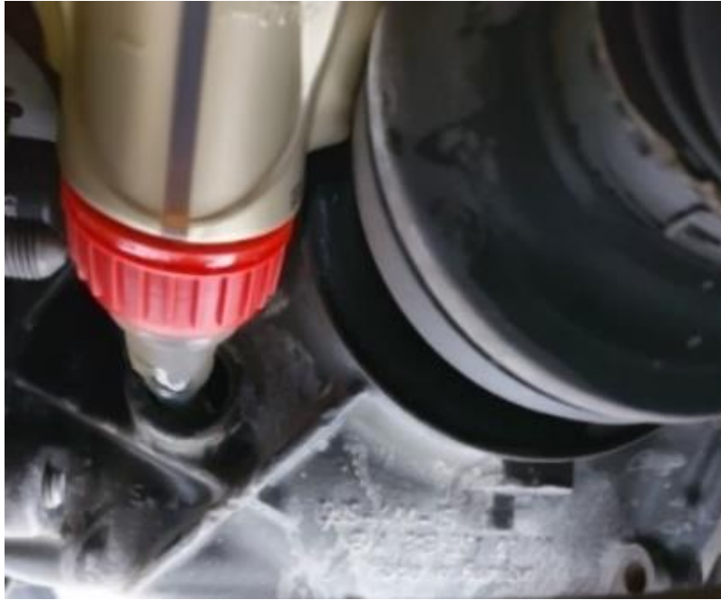
Figura 8- Reposição do óleo do diferencial
