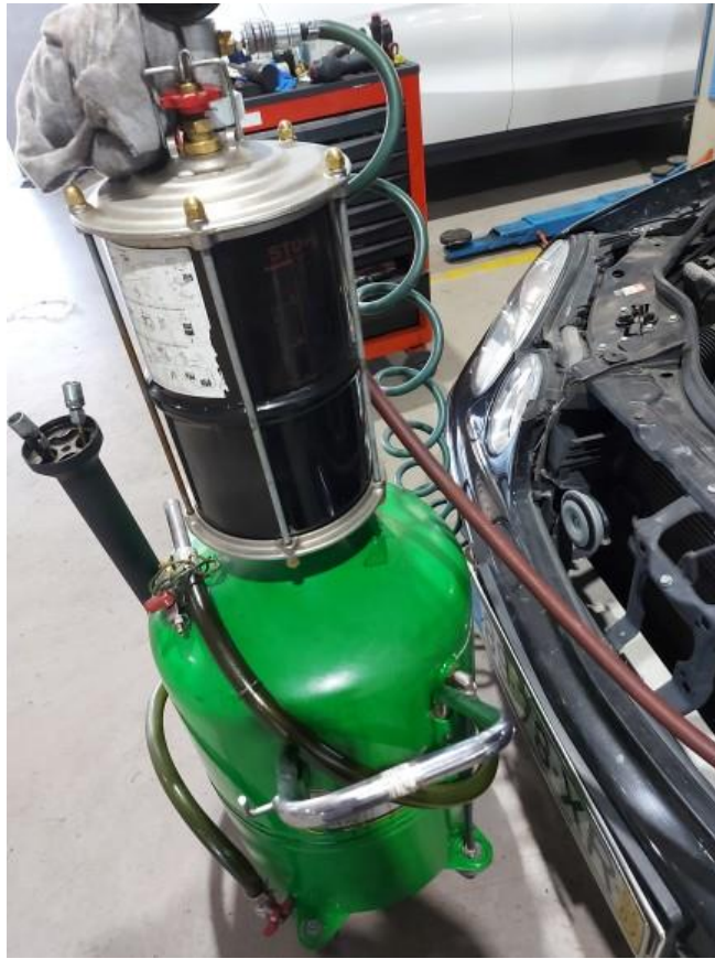
Figura 2- Aspirador de óleo
