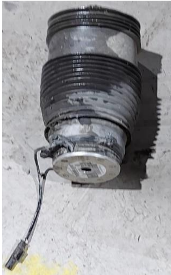
Figura 15- Amortecedor pneumático danificado
