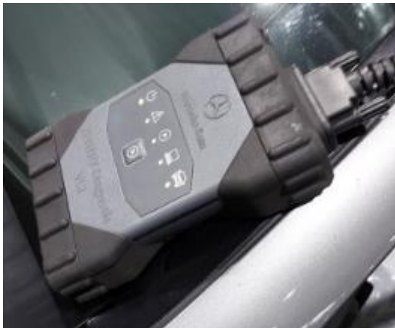
Figura 17- Aparelho de diagnóstico eletrônico
