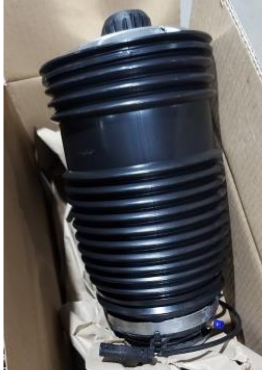
Figura 16- Amortecedor pneumático novo
