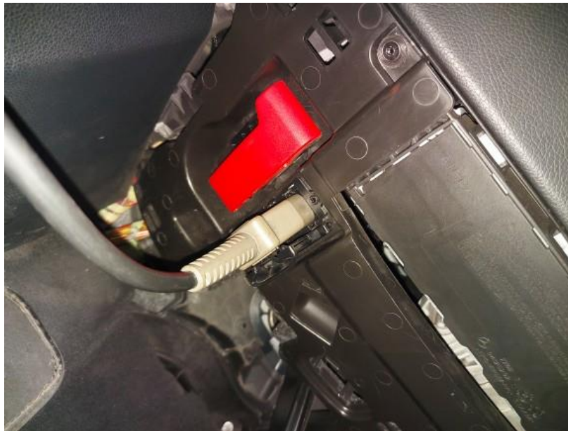
Figura 18- Cabo de ligação ligado na porta OBD-II
