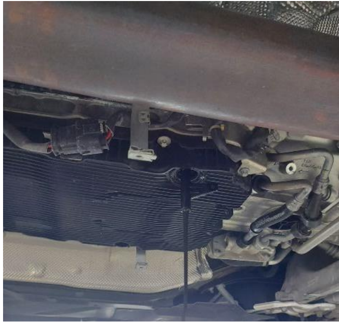
Figura 4- Drenagem do óleo da caixa de velocidades
