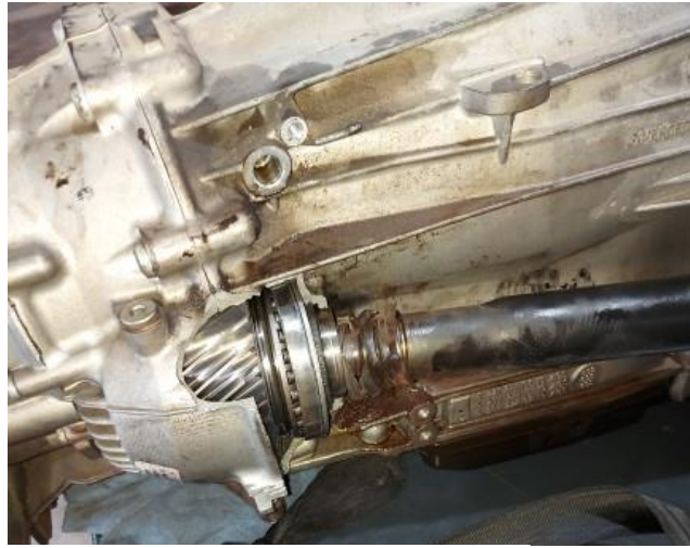
Figura 14- Caixa de velocidades danificada.
