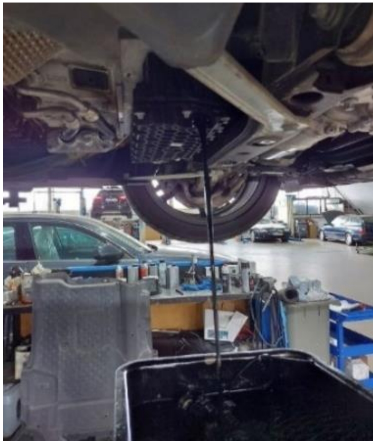
Figura 9- Drenagem do óleo do motor
