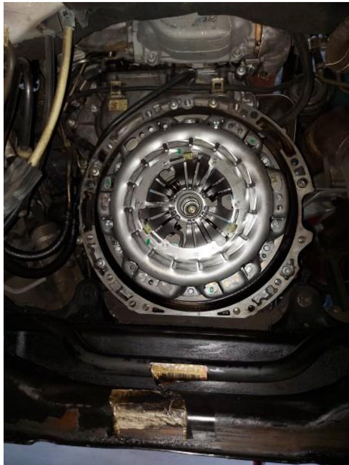
Figura 13- Embraiagem nova montada
