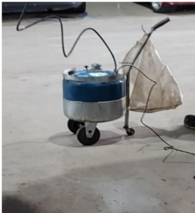
Figura 3- Sangrador de travões por pressão
