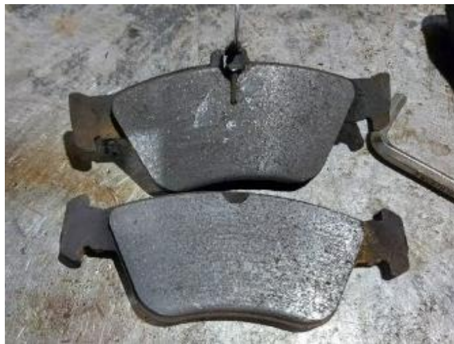
Figura 10- Pastilhas de travão desgastadas
