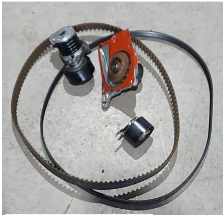
Figura 7- Correia, tensores e bomba de água
