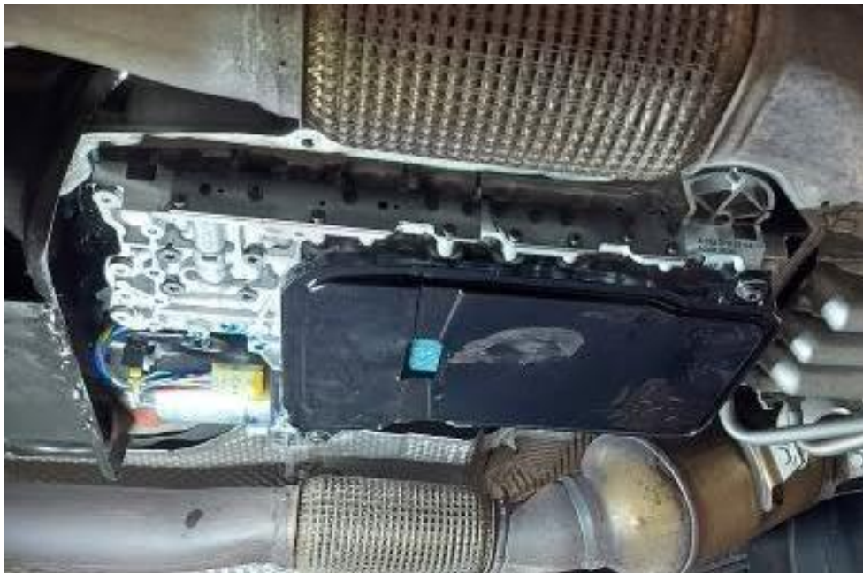
Figura 5- Filtro de óleo da caixa de velocidades
