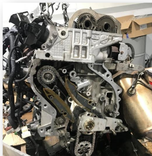
Figura 24 - Corrente de distribuição substituída
