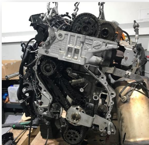
Figura 23 - Motor preso com ferramentas especiais
