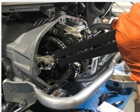
Figura 14 - Rodar o motor com ferramenta especial
