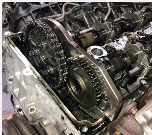
Figura 22 - Motor preso na árvore de cames
