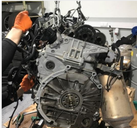
Figura 21 - Motor sem embraiagem e sem tampa de válvulas
