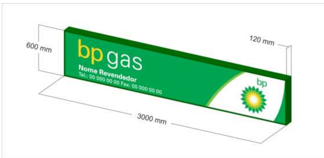
Figura 41 - Identificação da BP Gás aplicada no identificador luminoso exterior do revendedor
