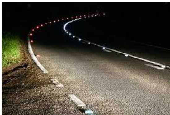
Fig. 62 – Efeito provocado pela incidência de luz nos marcadores
