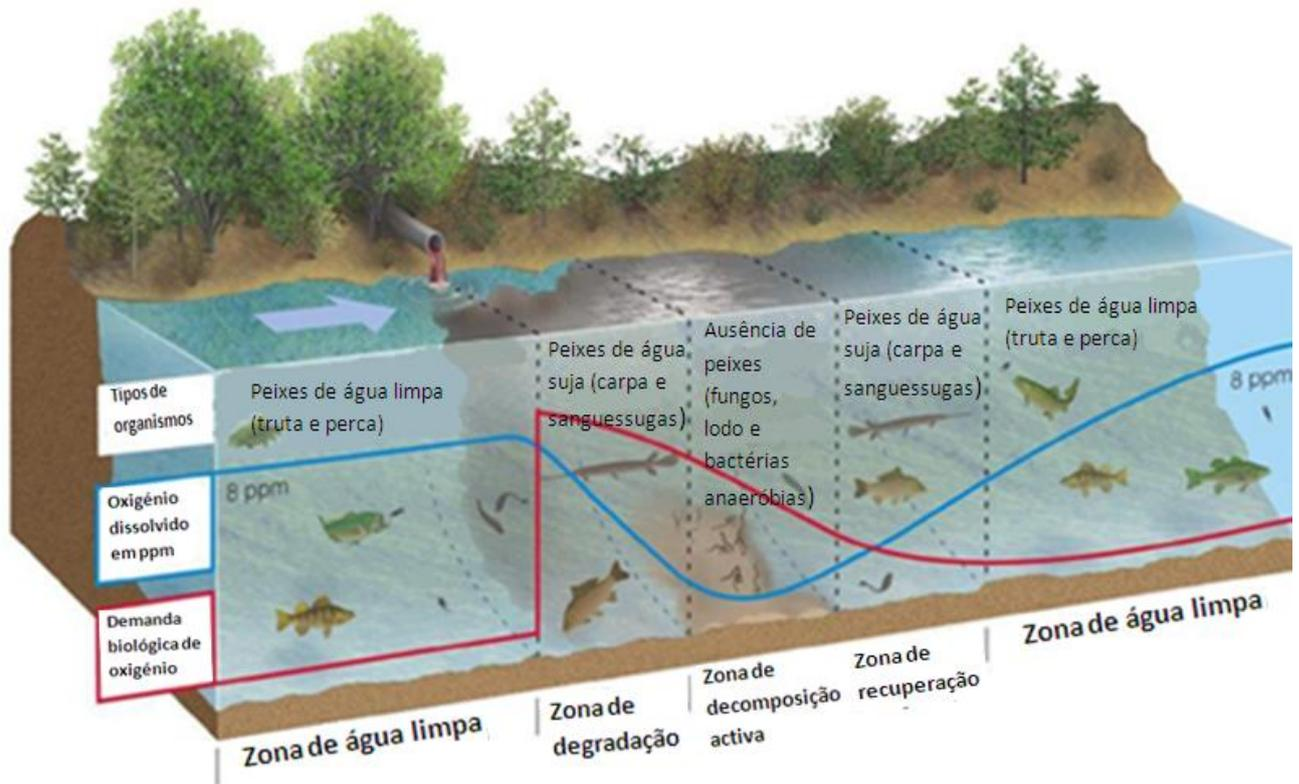
**Figura 3:** Perfil esquemático das consequências do lançamento de uma carga orgânica em curso de água, adaptado de Poluição das águas cap.5,2008.
