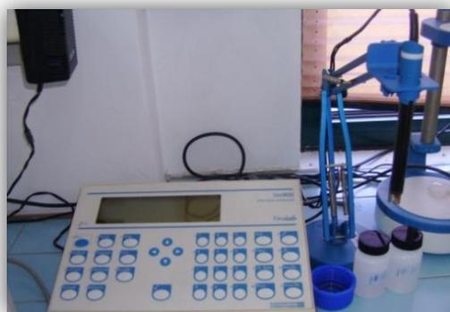
**Figura 16:** Medidor de pH.
