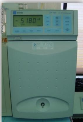
**Figura 26:** Cromatógrafo iônico.
