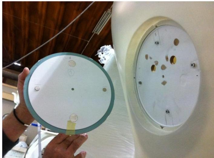
Fig. 84 – Teste de encaixe com ímanes.
