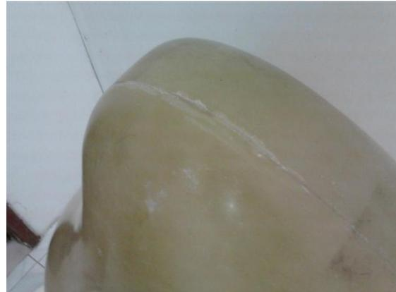
Fig. 72 – Deformação do molde.
