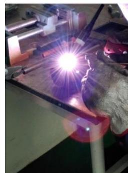
Figura 13- Soldadura com TIG
