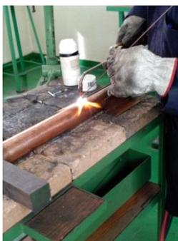
Figura 12 - Soldadura com oxiacetileno
