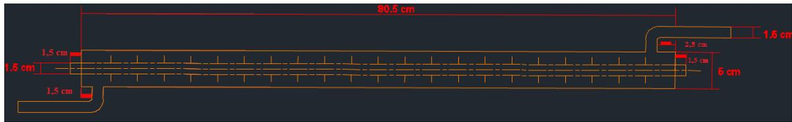
Figura 30- Esquema do permutador Finalizado
