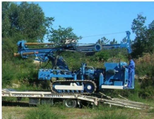
Figura 29. Máquina de perfuração [16]
