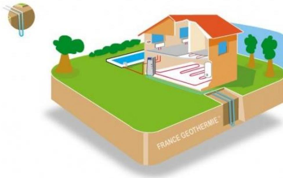
Ilustração 6. Esquema de aproveitamento de energia geotérmica de baixa entalpia por captação vertical, com bomba de calor.
