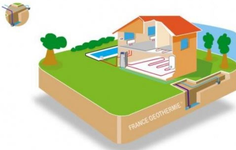
Ilustração 6. Esquema de aproveitamento de energia geotérmica de baixa entalpia por captação em lençol freático, com bomba de calor.
