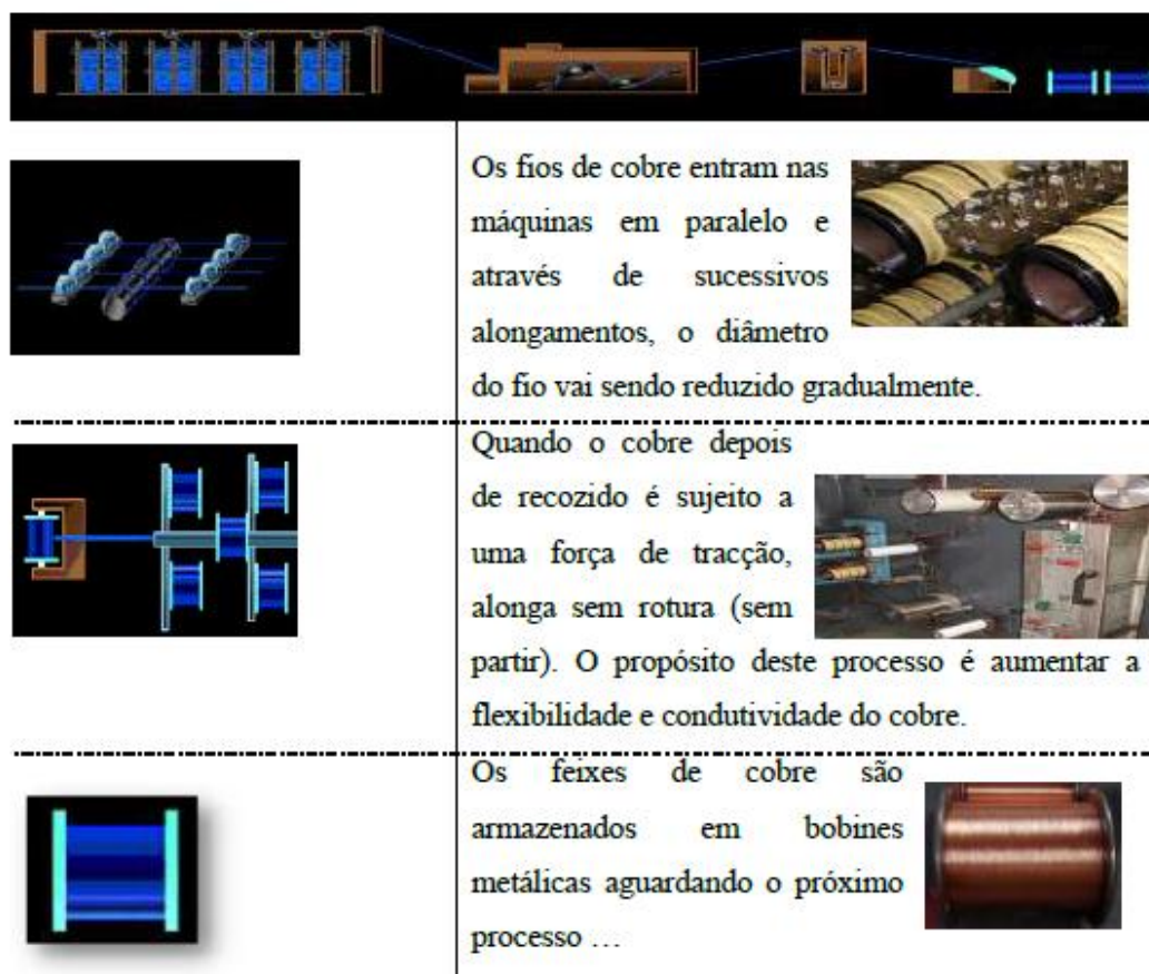
Figura 9- Processo de Trefilagem
