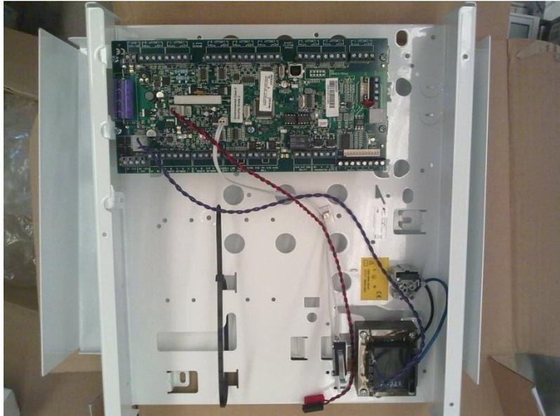
Combinação de interruptor contra sabotagem, detecta se a caixa for aberta ou se for removida da parede.
