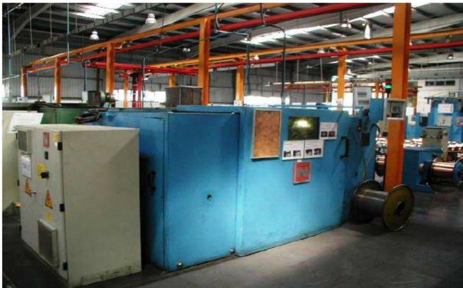
**Figura 11** - Processo de Torção
