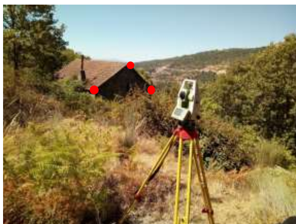
Fig. 82 Local escolhido para fazer o levantamento dos alçados (fonte própria)
