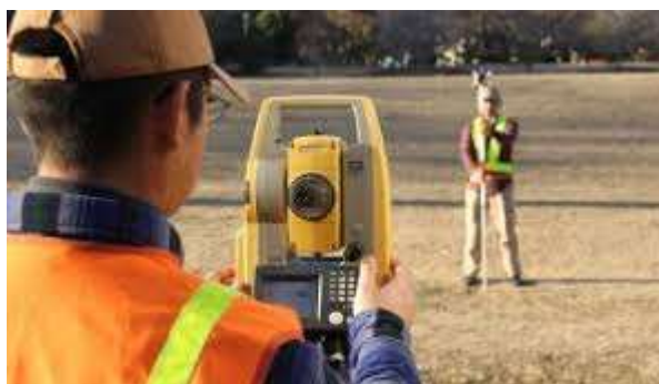
Fig. 2 Exemplo de recolha de dados com refletor
