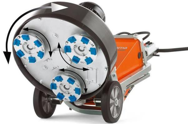
*Figura 8 – Máquina de discos diamantados [4]*
