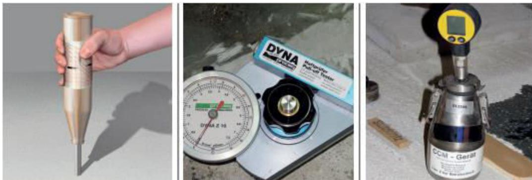
Figura 18 – Esclerômetro à esquerda, Pull-off ao centro, Higrômetro do substrato à direita [11]
