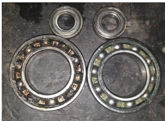
Figura 16 - Rolamentos substituídos dos motores
