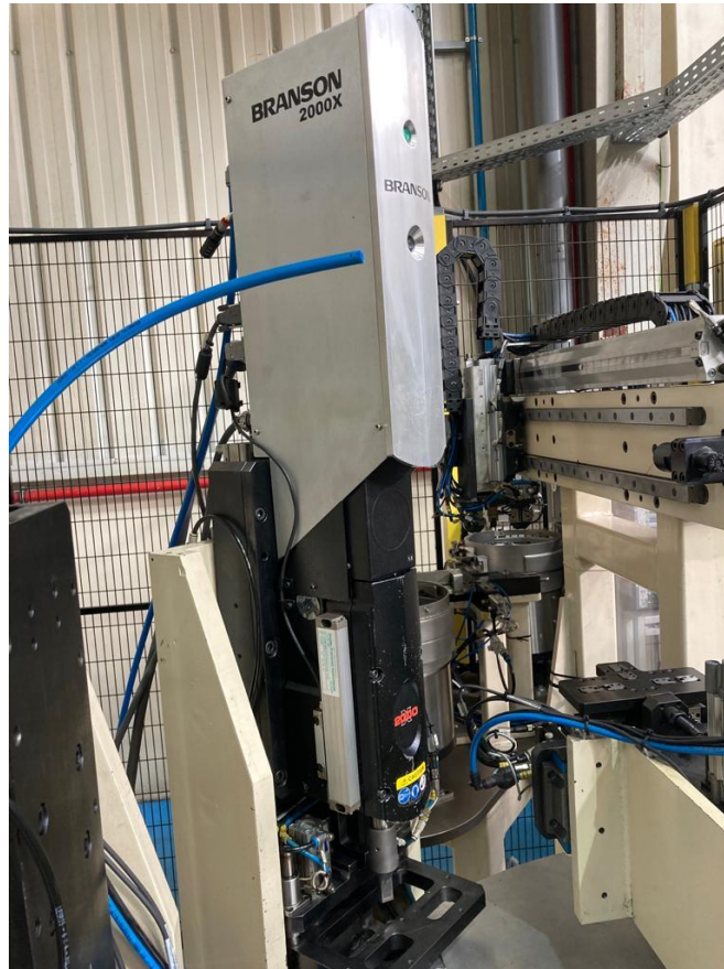
Figura 33 - Branson solda por ultrassons
