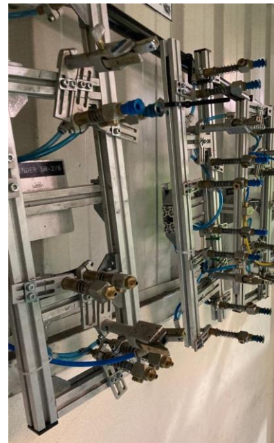
Figura 13 – Garras e ventosas da garra do robô
