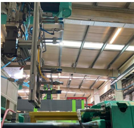
Figura 10 - Garra do robô
