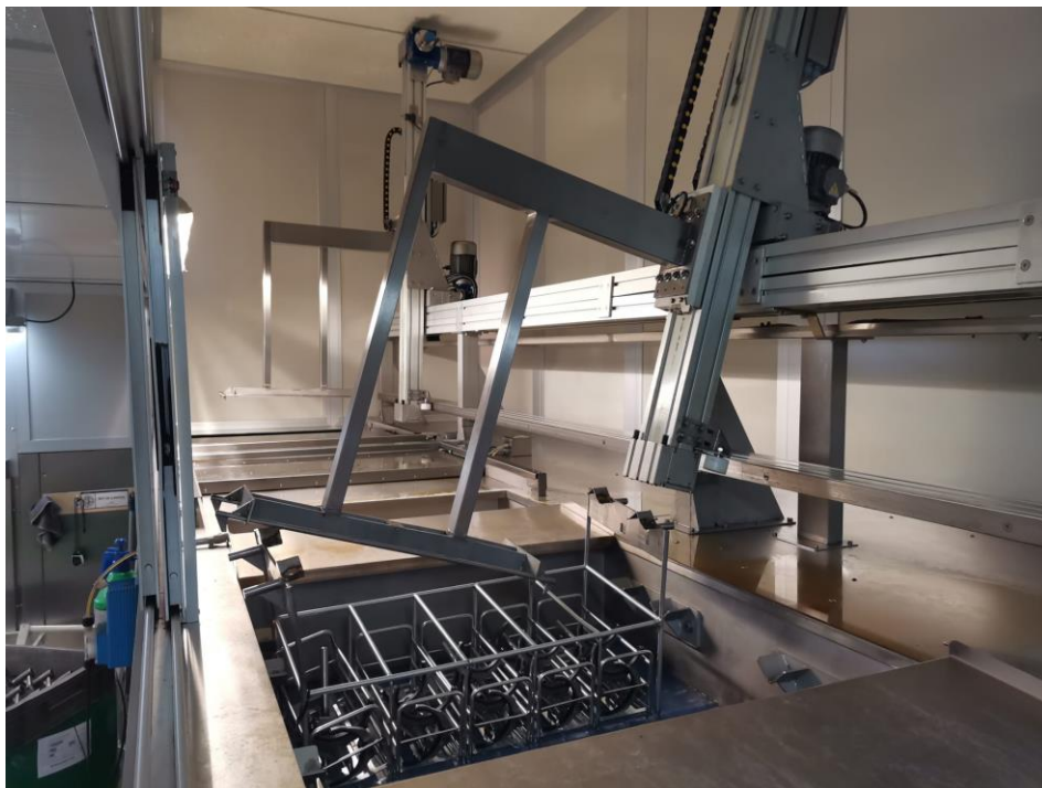
Figura 25 - Guias do robô empenadas
