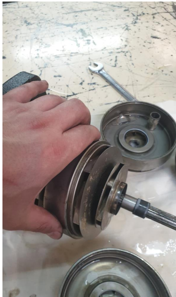
Figura 23 - Substituição de enpanque
