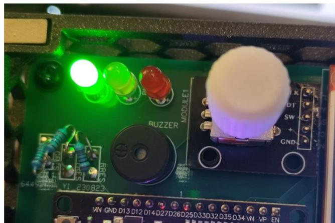
Figura 4.3 - Rotary encoder, buzzer, e leds do sistema
